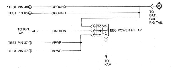
\*TEST PINS LOCATED ON BREAKOUT BOX.
