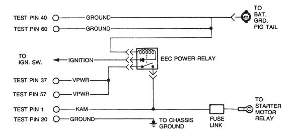
\*TEST PINS LOCATED ON BREAKOUT BOX.
