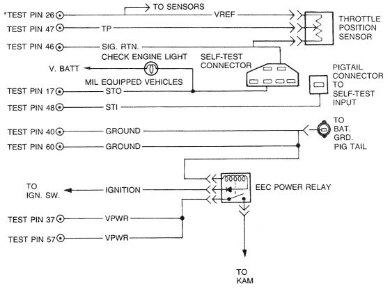
\*TEST PINS LOCATED ON BREAKOUT BOX ALL HARNESS CONNECTORS VIEWED INTO MATING SURFACE
