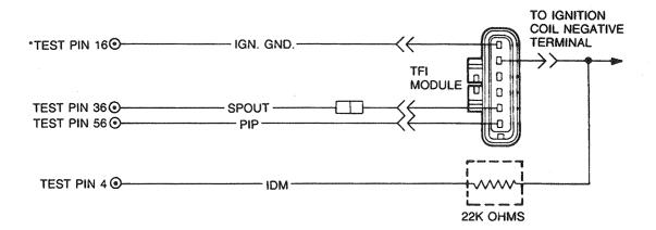
\*TEST PINS LOCATED ON BREAKOUT BOX ALL HARNESS CONNECTORS VIEWED INTO MATING SURFACE
