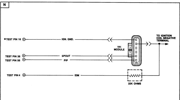
\* TEST PINS LOCATED ON BREAKOUT BOX.
