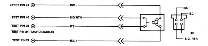
\*TEST PINS LOCATED ON BREAKOUT BOX.
